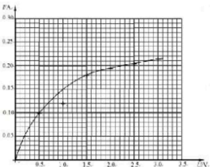
**【解题思路】**①甲电路采用的是电流表外接法，故测得的电流会偏大，故计算的电阻值会偏小；②由于灯泡的规格为“3.8V 1.1W”，故额定电流为  $I = 1.1W / 3.8V = 0.29A = 290mA$ ，故电流表选用量程为 500mA 的电流表 B；滑动变阻器选用阻值较大的 C。如果选 D 的话，通过变阻器的电流会大于 0.5A，从而烧坏滑动变阻器；③第 7 组数据通过描点的方法在图上标出即可，然后用平滑的曲线将各点连接起来即可，特别离谱的点可以不管它；④若灯泡的电阻不变，则图线是直线，现在灯泡的电阻在随电压的增大而增大，故其图像为 C。
