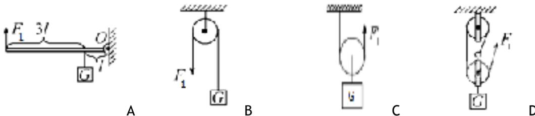
【解析】A. 由杠杆平衡原理  $F_1 \times 3l = G \times l$  得， $F_1 = \frac{G}{3}$ ；
