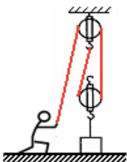
【解析】由于人站在地面上，所以小明的手开始，先绕过定滑轮，再绕过动滑轮，最后系在定滑轮下面的挂钩上，如图：
