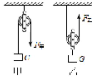
【解析】不计绳重与摩擦，用甲、乙两种方式在相同时间内将同一物体匀速提升相同高度  $h$  时，甲图是定滑轮，拉力做功为克服物体重力做的功  $W_{甲} = Gh$ ；
