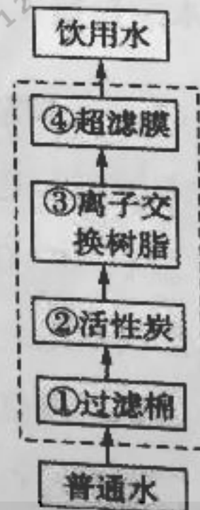
图2 生命吸管净化过程
