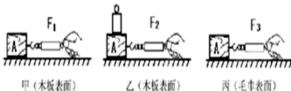
(1) 实验过程中，必须用弹簧测力计沿水平方向拉着物块 A 做 \_\_\_\_\_ 运动，这样做便于测量滑动摩擦力的大小。
