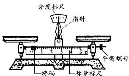
(1) 调节天平时应将\_\_\_\_\_移至零刻度处，然后调节\_\_\_\_\_，使天平横梁平衡。
