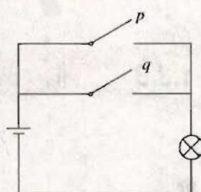
我们可以从并联电路理解联结词“或”的含义. 若开关  $p$ ,  $q$  的闭合与断开对应命题的真与假, 则整个电路的接通与断开分别对应命题  $p \vee q$  的真与假.
