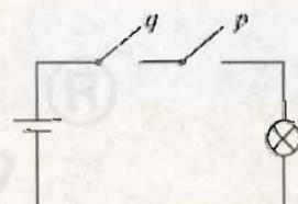
我们可以从串联电路理解联结词“且”的含义。若开关  $p, q$  的闭合与断开分别对应命题  $p, q$  的真与假，则整个电路的接通与断开分别对应命题  $p \wedge q$  的真与假。
