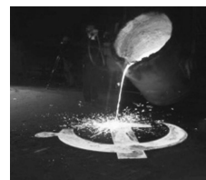
D.钢水浇铸得到钢件
